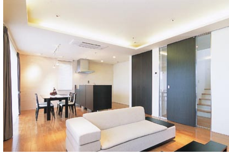
ハイスタッドの建具と折り上げ天井で実際よりも天井が高く感じられ、開放的なリビング。玄関ホールとの間仕切りの両サイドFIX窓を設け、ホールと視覚的なつながりを確保
