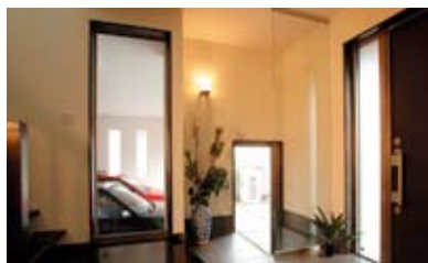
フィックス窓で間仕切りを設けたガレージへは、玄関から階段を数段下りて出入りできる設計
